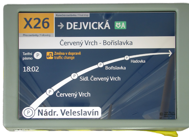
Obrázek 15: Vnitřní LCD v autobusu SOR. Výlukové linky mají číslo podbarvené žlutě, běžné bíle.
