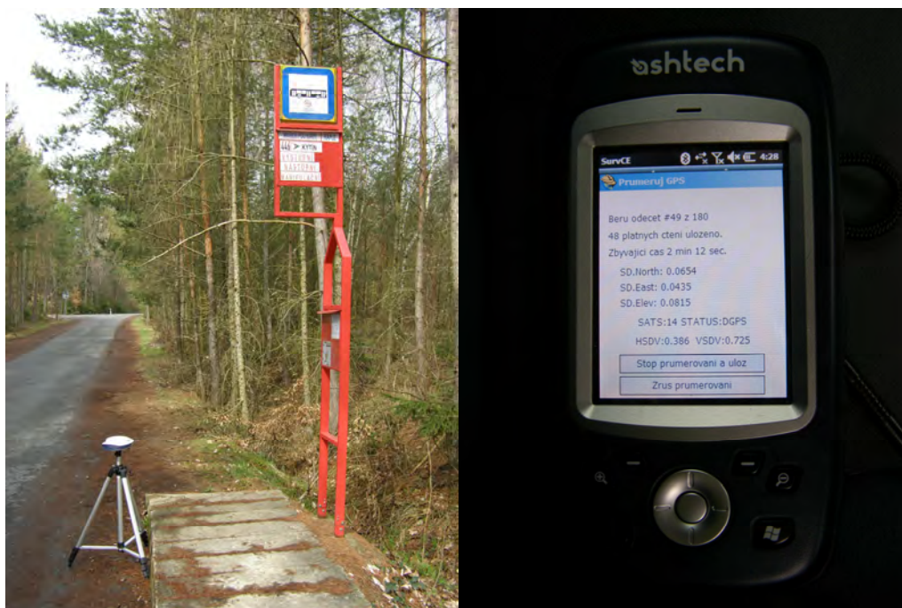
Obr. 21 – Ukázka z průběhu přeměřování souřadnic zastávkových sloupků, vlevo geodetická GPS v pozici pro měření, vpravo PDA ukládá a následně průměruje hodnoty z geodetické GPS, foto: autor
