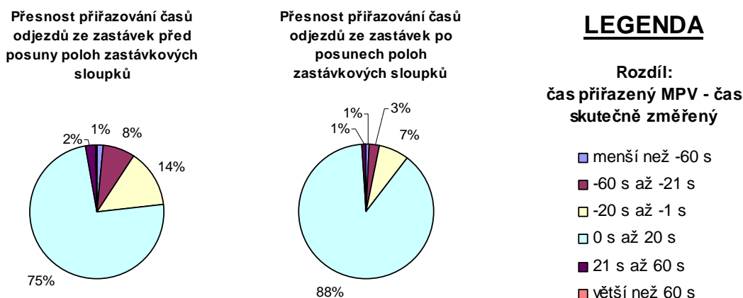
Graf 12 – Přesnost přiřazování časů odjezdu u všech zastávkových sloupků, kde došlo k posunu polohy
