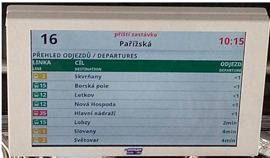
Obrázek 3: LCD společnosti Herman komunikující přes EPISNET (Autor, 2019)
