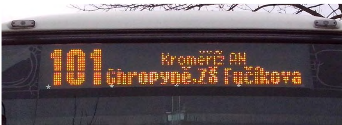
Obrázek 2: textový mód zobrazovacího panelu EmTest (Daniel Kelnar, 2015)
